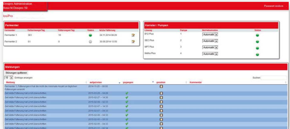
Auf der Startansicht von DosiPro im Internetportal von N-E-St kann der Biogasanlagenbetreiber sehen, welche Spurenelemente wie oft in das Gärsubstrat dosiert werden.
