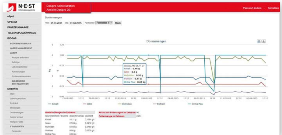
Die Grafik zeigt den Verlauf der täglichen Dosiermengen. Ein hinterlegter Rechenalgorithmus reduziert oder erhöht die Mengen je nach Bedarf.
